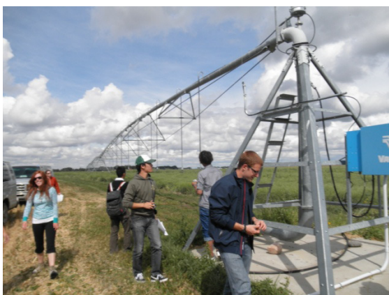
写真 センターピボット
