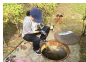
消雪用井戸からの地下水採取
