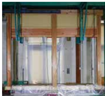
差し鴨居接合部を有する垂れ壁の軸組実験
