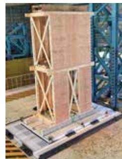
滑り基礎構造を有する木造軸組の振動台実験
