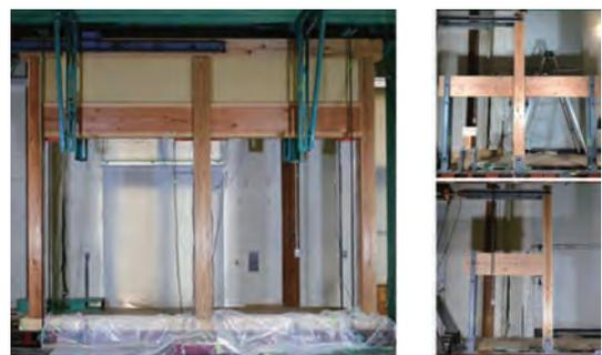
差し鴨居接合部を有する垂れ壁の軸組実験 接合部要素実験
