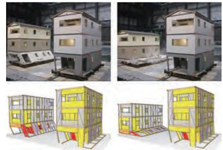
シミュレーションによる振動台実験の再現
