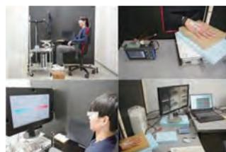
木材の接触温冷感を経時的に測定。
