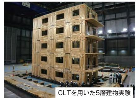
CLTを用いた5層建物実験
