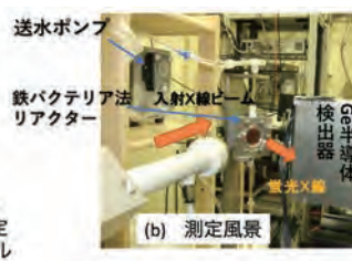
図7. SPring8における連続通水条件下でのXAFS測定による砒素除去機構解明
