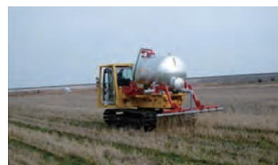
圃場でのメタン発酵による液肥散布
