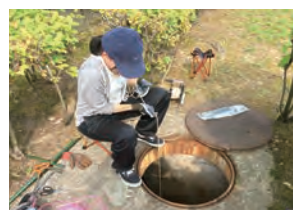
消雪用井戸からの地下水採取
