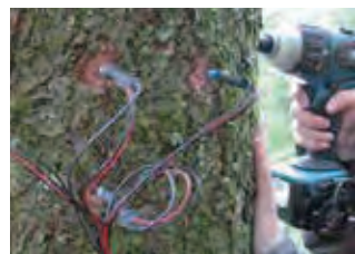
ヤマザクラの幹に取り付けられた樹液流速計測センサー。
