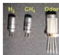
シロアリの代謝ガスを検出するガスセンサ
