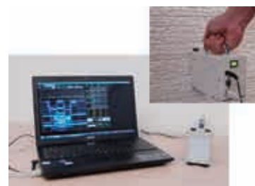
電磁波レーダを用いた木質構造体の診断装置
