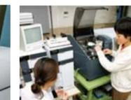
分子の重さを量る装置です。超微量物質の構造を決定したり、量を測定するために用います。
