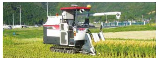
ロボットコンバインによる稲収穫
