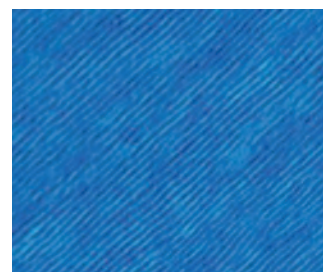
セルロース液晶の磁場配向により作製した光学フィルム。
