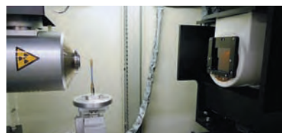
マイクロフォーカスX線CTによる木材内部の非破壊計測(2010)。
